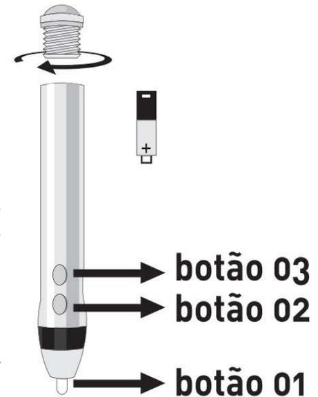
**NOTA:** Os Botões 01 e 02 tem a mesma função, portanto para evitar erros na utilização do sistema acione apenas um deles em função do tipo de superfície. A funcionalidade de movimentação do mouse inicia-se após o uso de qualquer função da caneta e se desliga automaticamente após 10 segundos.
